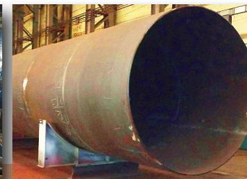
Сварные трубы из обечайек
