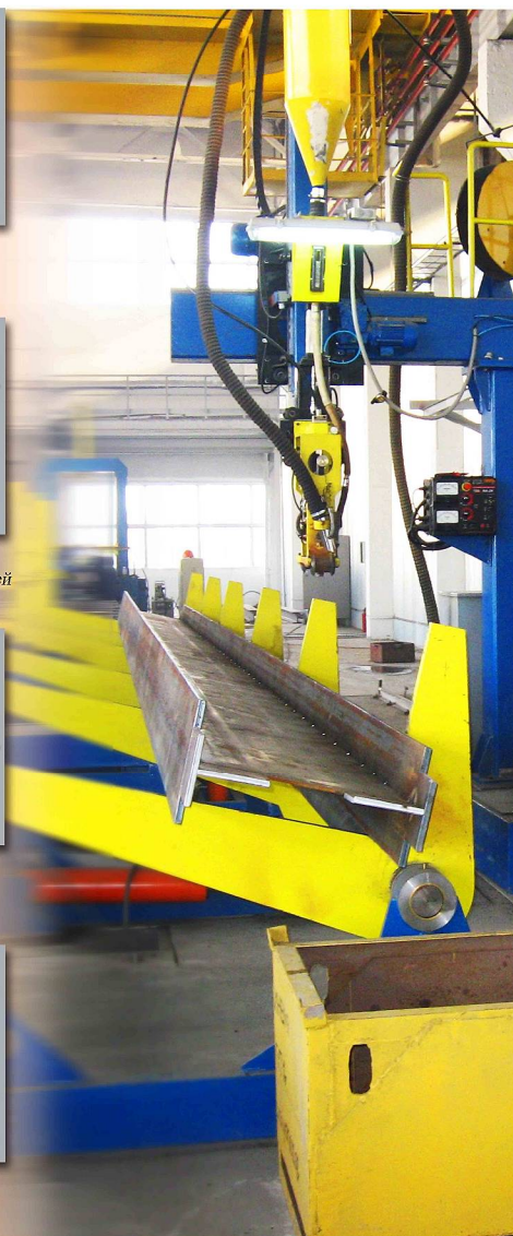
Облегченная балка с «окнами» в стенке с сохранением всех механических параметров
